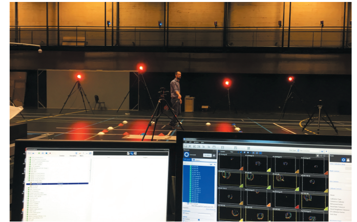
Figure 1: Gymnase dédié à l'analyse du mouvement où sont disposées les caméras infra-rouges permettant la collecte des coordonnées des marqueurs au cours du mouvement – étape de calibration.
