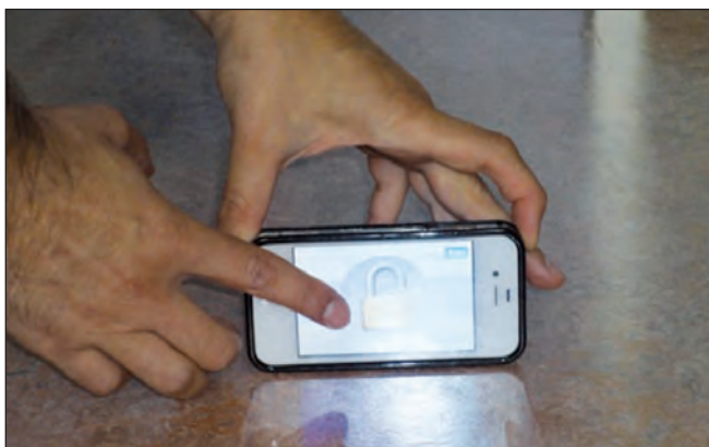
» » Figure 3: mise à zéro de l'application pour smartphone sur un plan horizontal (le sol par exemple)
